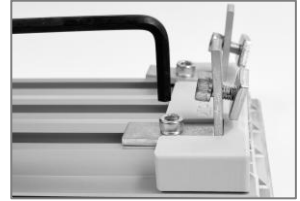
Die Winkel festschrauben und die Montagehilfe entfernen
