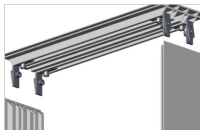
Eckwinkel gleichzeitig zusammenstecken und Schrauben festziehen
