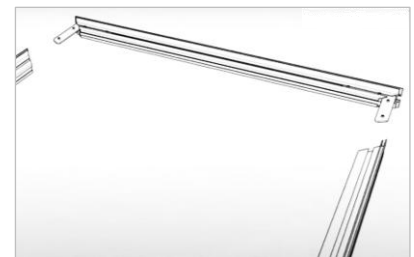
Die letzten beiden Eckwinkel gleichzeitig zusammenstecken und Schrauben festziehen
